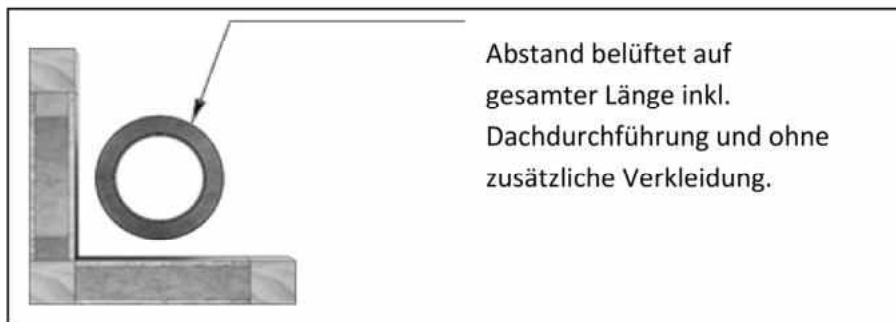
Abbildung 2: Abstand zu brennbaren Materialien
